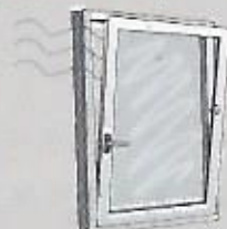
Ouverture en OBTF pour l'aération, ouverture à la française uniquement avec une clé
